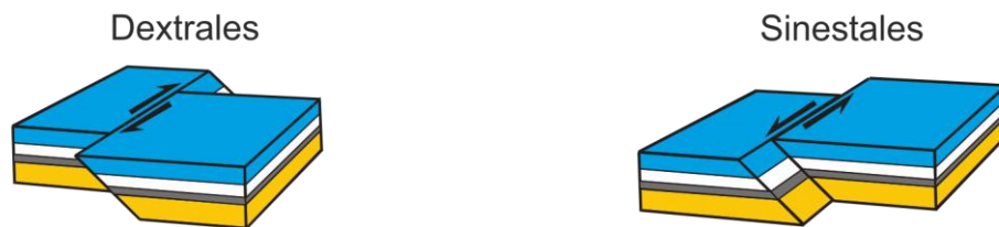
Figura 40. Nomenclatura de las fallas según la dirección y el sentido del desplazamiento relativo de los bloques fallados.
