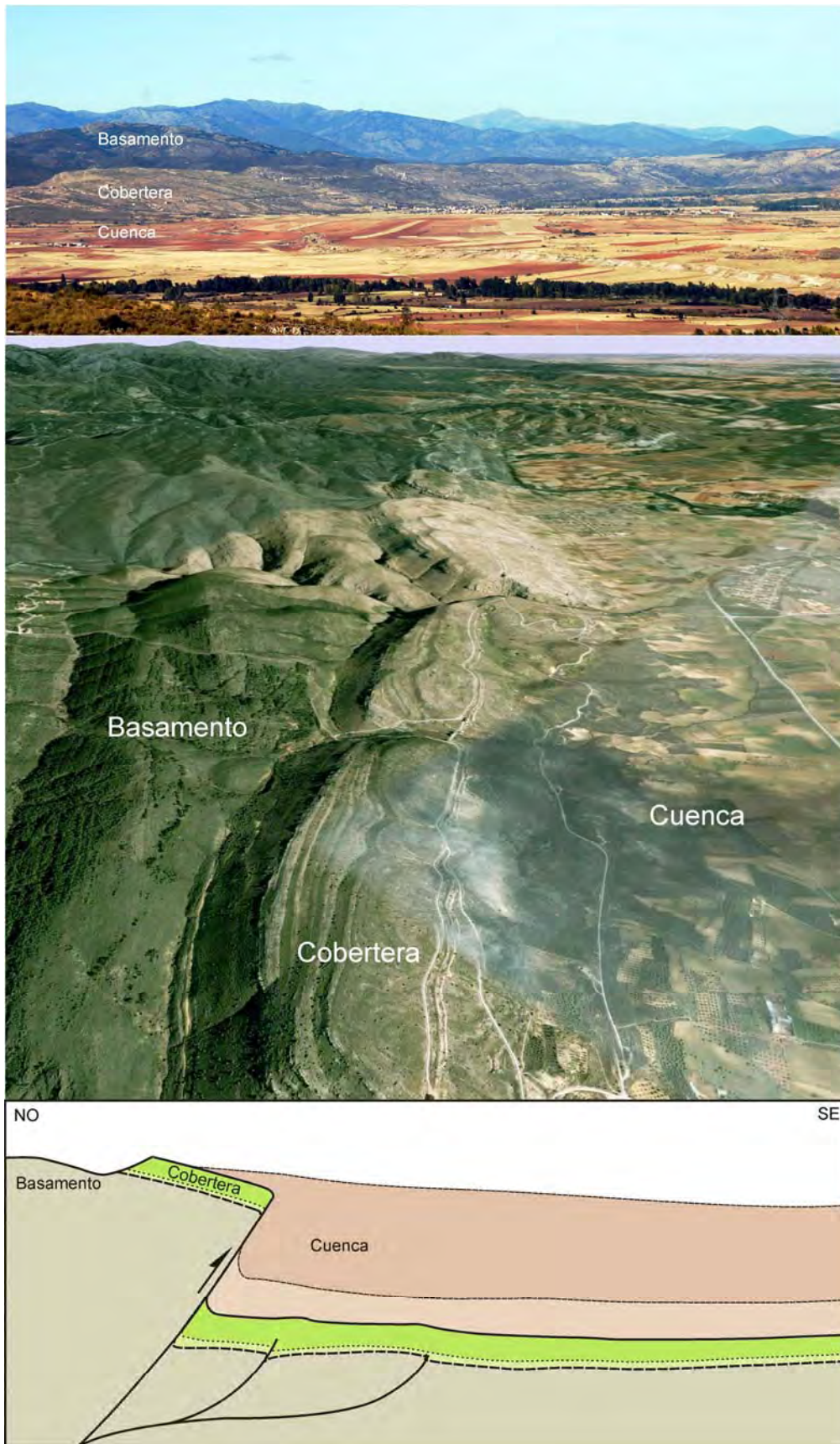
Figura 7 Vistas en campo, aérea y en corte de las “cuestas” del norte de Torrelaguna que ilustran el concepto de basamento, cobertera y cuenca.
