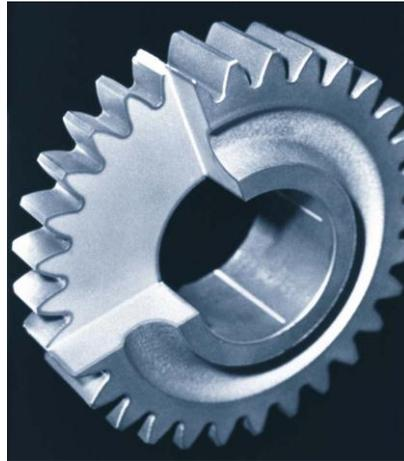
Figura 10. Engranaje cementado- Sección de dicho engranaje donde se aprecia la zona oscura exterior carburada.
