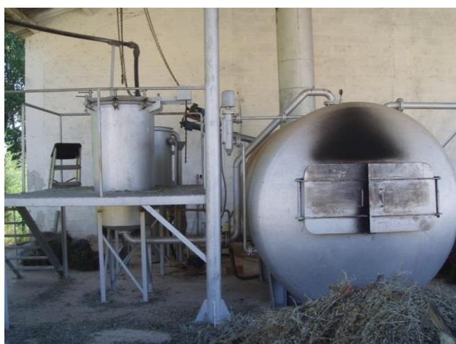
**Figura 3. Réplica de una destiladora industrial por arrastre en corriente de vapor y alimentación por biomasa. Centro de Investigación Agraria de Albaladejito (Cuenca).**
