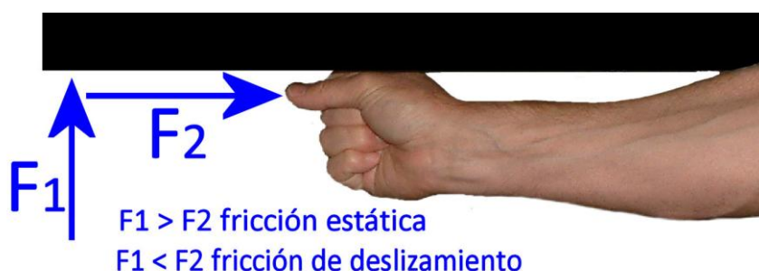
Figura 2. Fuerzas de fricción: Comprobar con el tablero de una mesa apretando con el puño desde abajo, moverlo lentamente, hay una fuerza de fricción que controla el movimiento; si dejamos de hacer fuerza, la mano se desliza rápidamente, hay fricción de deslizamiento sin control sobre el movimiento.
