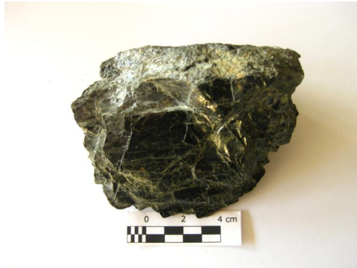
Figura 3. Cristales de hábito laminar de biotita. Observa su color oscuro y el brillo vítreo característicos.
