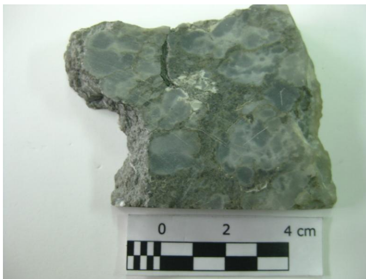
Figura 6. Sección pulida de una muestra masiva de anhidrita con textura marmórea.
