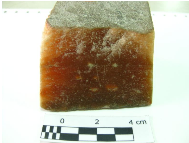
Figura 3. Silvinita (mezcla de halita y silvina) con coloraciones rojizas debido a las impurezas.
