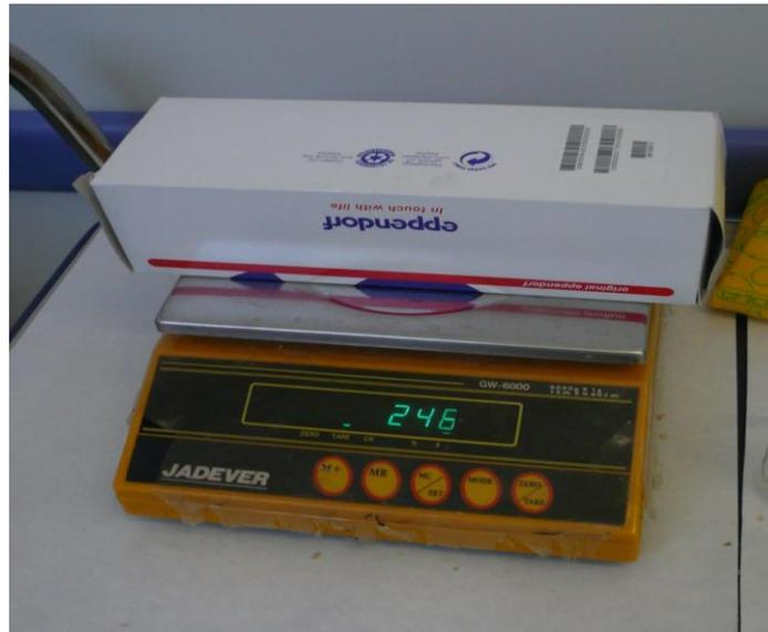
**Figura 3.** Forma de pesar las ratas. La rata se introduce en una caja de cartón estrecha que puede cerrarse. Esto evita las oscilaciones de peso que suelen producirse cuando la rata se pesa en un recipiente abierto.
